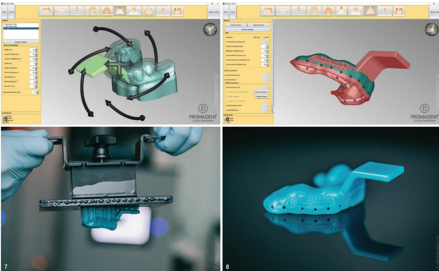
**Abb. 5:** Zwei Optionen für die Löffelgriff-Gestaltung: 1. Konfektioniertes Design, das individualisierbar ist. 2. Individuelles Design im CAD-Zeichnungstool. **Abb. 6:** Einstellen von Löffelperforationen. **Abb. 7:** Der Druck des konstruierten Löffels kann in jedem offenen 3D-Drucksystem erfolgen. **Abb. 8:** Fertiger Löffel für die Übergabe an die Zahnarztpraxis.
